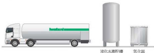
液化水素貯槽 気化器
